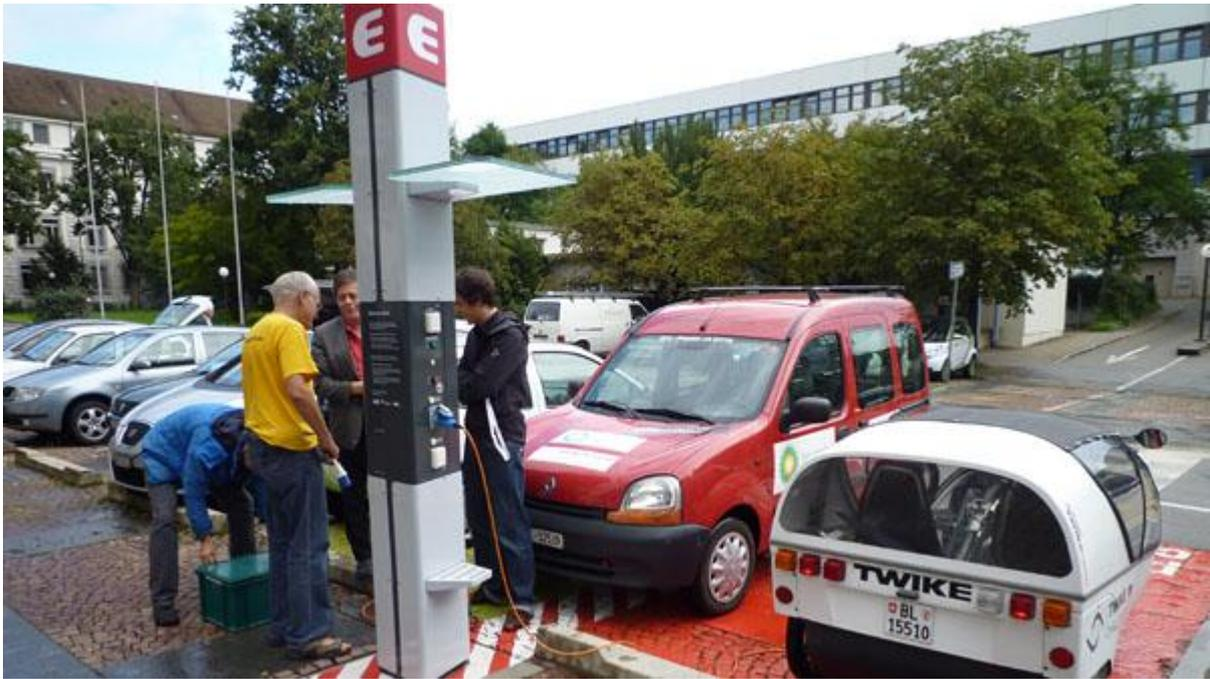
Um mit der Intelligenz der Stromtankstelle umgehen zu können braucht es ein paar Tipps. Zum Beispiel muss man den Schlüsselschalter solange drehen, bis der Netzstrom genügend gross ist, sonst spricht die Stromüberwachung der Säule zu früh an.
