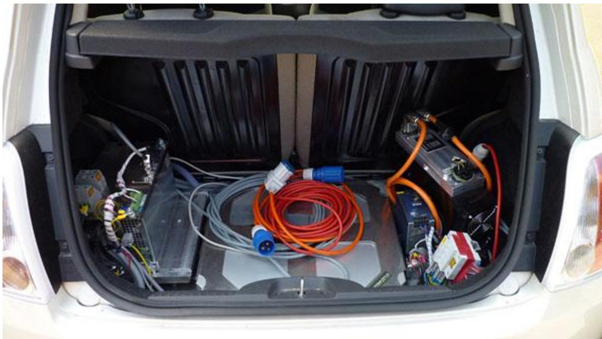
Ein Einblick in den Kofferraum des Cinquecento Hybrid von Swisscleandrive. In der Reserverad-Mulde ist die versenkte Fahrbatterie zu sehen (dreifels Lithium Power mit rund 420V Spannung), links die AMK-Motorsteuerung, rechts das Ladegerät. Eine Herausforderung war die Unterbringung der zusätzlichen Komponenten im Panda 4x4 Chassis und die Integration in die Fahrzeugelektronik.
