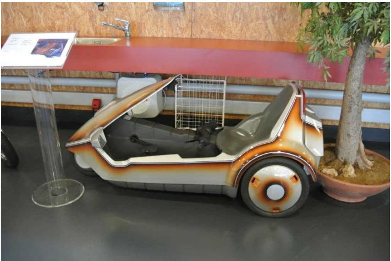
Sinclair C5 Elektrofahrzeug (ca. 1985) mit 45 kg Leergewicht, einer Höchstgeschwindigkeit von 25 km/h, einer Reichweite von 40 km (Werksangabe) und einer 12V/36 Ah Bleibatterie
