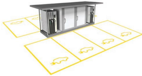
**Abbildung 30:** Beispiel für die Auslegung einer möglichen künftigen Ladestation von Elektrofahrzeugen an einer Autobahnraststätte mit 4 «parallelen» Stationen und einem zentralen Speichersystem.
