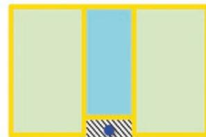
**Abbildung 15:** Abbildung einer möglichen Integration eines Parkplatzes für Motorräder/vierrädrige Leichtfahrzeuge (in blauer Farbe hervorgehoben) mit 2 Parkplätzen, die für Automobile reserviert sind. Ein praktisches Anwendungsbeispiel für solche Auslegung wird in der **Abbildung 18** vorgestellt.
