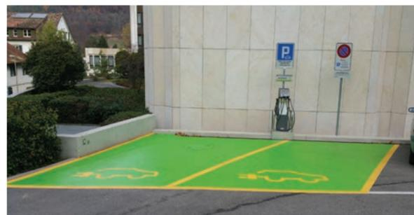
**Abbildung 21:** Beispiel der horizontalen und vertikalen Beschilderung für einen Parkplatz, der für das Laden von Elektrofahrzeugen reserviert ist. Weitere Angaben müssen je nach Art des Parkplatzes angepasst werden.
